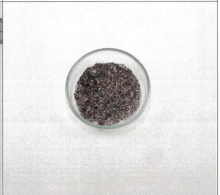
附圖十一：耐污染性試驗 (污染物質照片：香煙煙垢)
